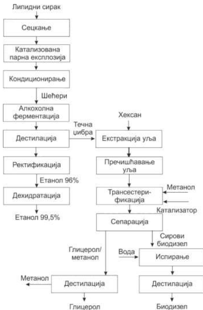
Сл. 6.9 Шематски приказ биорафинеријског процеса производње биоетанола, биодизела и глицерола из целе биљке липидног сирка
