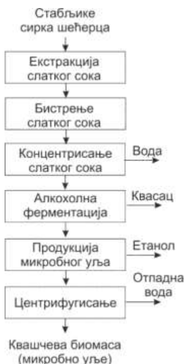
Сл. 6.10 Шематски приказ копроизводње етанола и биодизела из сирка шећерца
