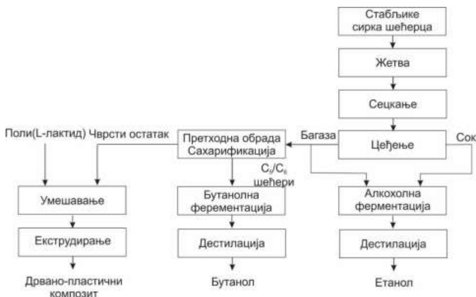
Сл. 6.4 Шематски приказ биорафинерије на бази стабљика сирка шећерца за производњу етанола, бутанола и дрвено-пластичних композита [68]
