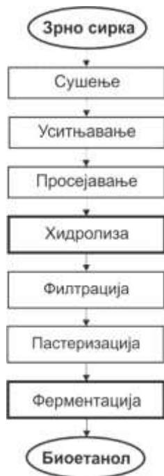
Сл. 4.5 Производња биоетанола из зрна сирка (адаптирано према [6])
