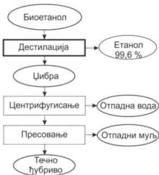
Сл. 4.6 Издвајање и концентрисање биоетанола (адаптирано према [6])
