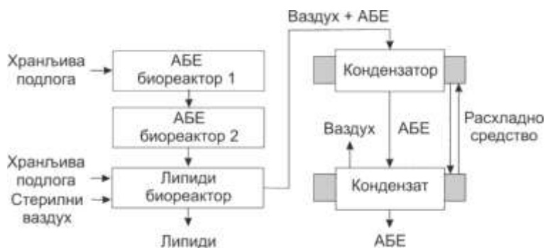
Сл. 6.5 Шематски приказ биорафинерије на бази багазе сирка шећерца за производњу органских растварача и микробних липида (АБЕ – ацетон, бутанол и етанол)
